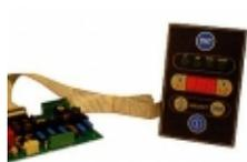
Commande électronique avec système autodiagnostic pour détecter d'éventuels défauts
