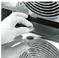
Cuve diamantée avec évacuation des eaux de dégivrage et de nettoyage Bac de récupération sous la cellule
