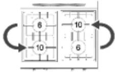
Position des brûleurs interchangeable après installation. Option remplacement d'un brûleur 6 kW par un brûleur 10 kW
