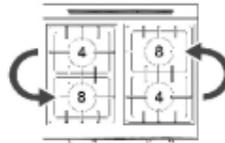
Position des brûleurs interchangeable après installation. Option remplacement d'un brûleur 4 kW par un brûleur 8 kW.
